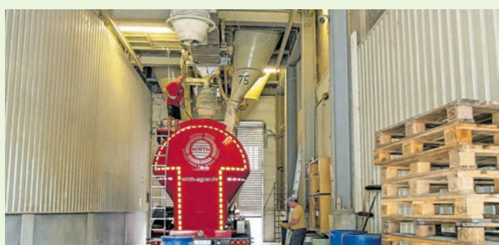
Mühlengebäude sind vorwiegend hoch, um durch die natürliche Schwerkraft zusätzliche Produktüberhebungen zu sparen. Müller Herbert Müller (rechts) verlädt Biofutter in einen Silozug. Mengen ab drei Tonnen werden lose verkauft, sodass ganze Touren mit circa 25 Tonnen entstehen.
